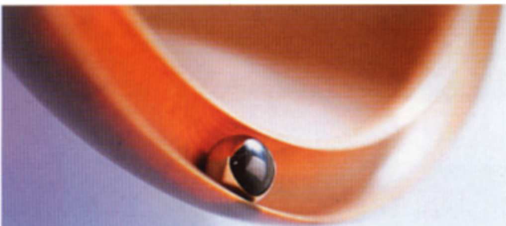
■ Spielerei als handwerkliche Herausforderung. Der Gefässrand der Kugelschale ist so gedreht, dass die Kugel zwar eingesetzt werden, aber nicht mehr herausfallen kann.
