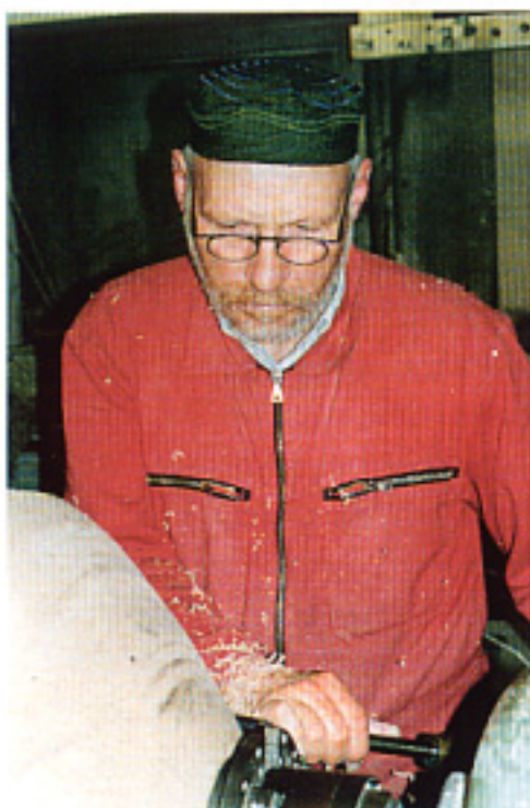
■ An seiner Drehbank bearbeitet Siegfried Schreiber jedes Objekt in vielen Etappen über die fünfjährige Trockenzeit.
